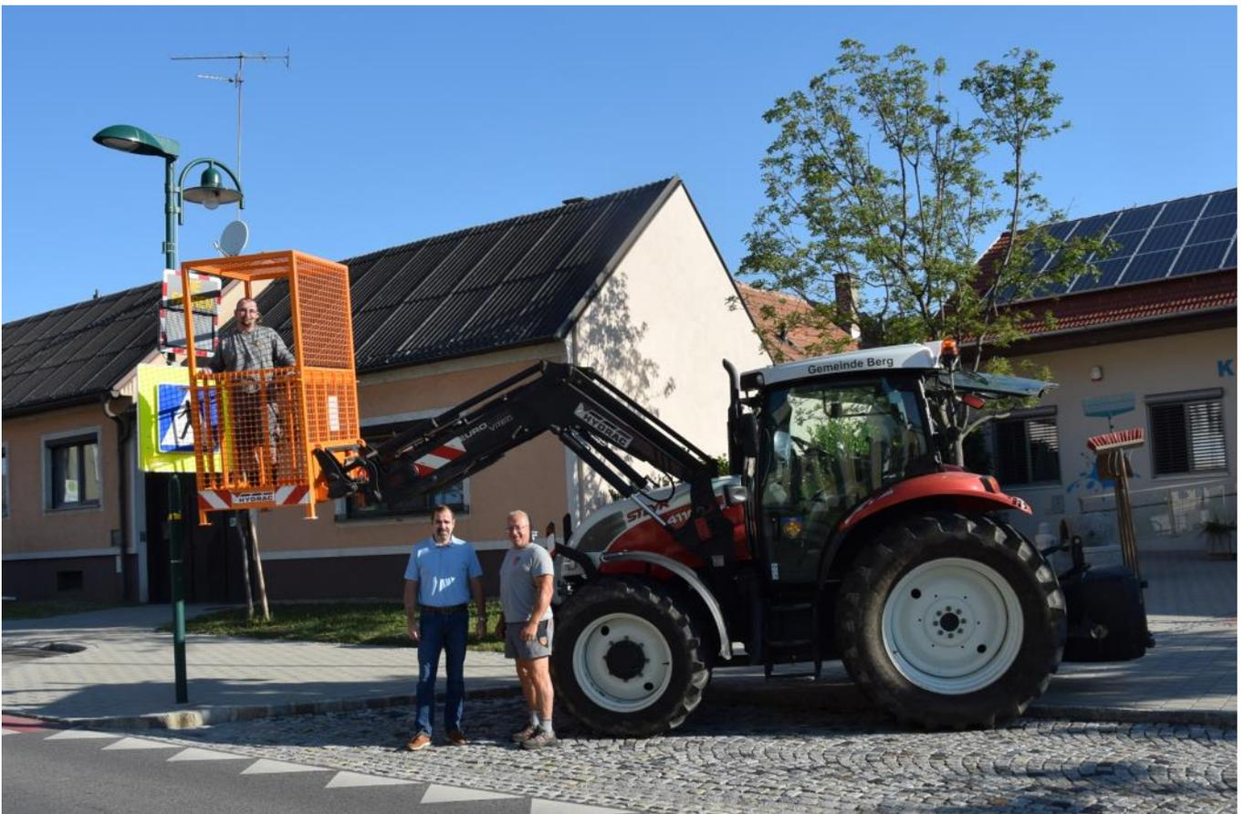
Wir arbeiten für Sie – und nun auch unter Einhaltung höchster Sicherheitsstandards. Aus diesem Grund wurde für den Bauhof nun ein Arbeitskorb angeschafft, der sowohl am Traktor als auch am Stapler für Arbeiten in luftiger Höhe eingesetzt wird. Das neue Arbeitsgerät wurde bereits vom TÜV abgenommen und in den Dienst gestellt. Bgm. Andreas Hammer inspizierte den Arbeitskorb gemeinsam mit den Bauhofmitarbeitern Andreas Hartl und Martin Denk vorab.
