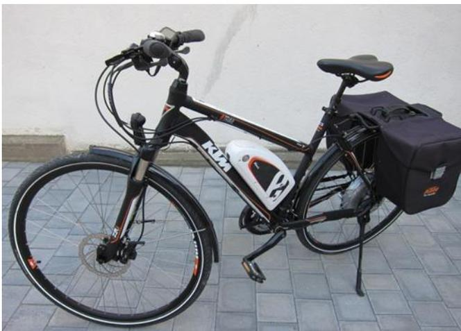
längere Distanzen und Steigungen zurückzulegen, oder aber höhere Durchschnittsgeschwindigkeiten zu halten. Pedelecs unterscheiden sich durch Batterie, Steuerung und Hilfsantrieb von herkömmlichen Fahrrädern. Neben der technischen Leistungsfähigkeit dieser Komponenten hat auch ihre Positionierung einen wichtigen Einfluss auf die Fahreigenschaften eines Pedelecs. **Beim Kauf eines Pedelecs sollten sie jedenfalls darauf achten, dass folgende Punkte erfüllt werden:**
