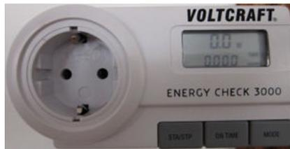
Eine gute Möglichkeit seine Stromfresser zu finden sind Strommessgeräte. Einfach zwischen Steckdose und Stecker des Geräts
